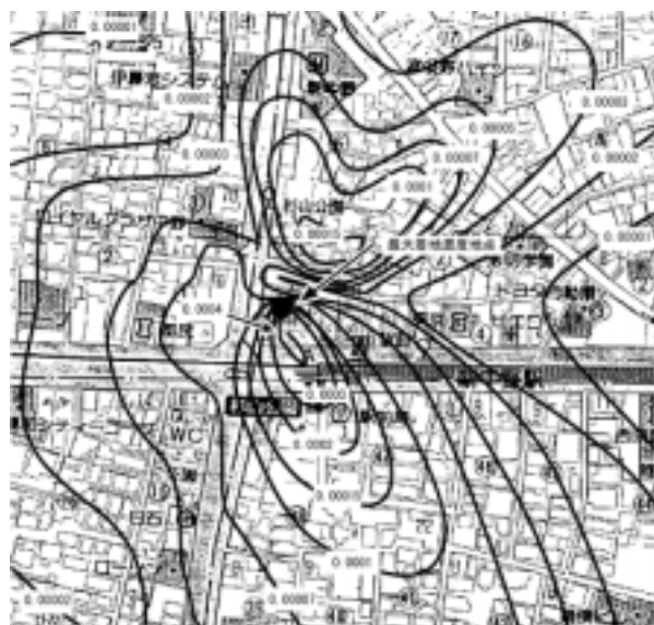
図1 拡散式による大気汚染評価結果
