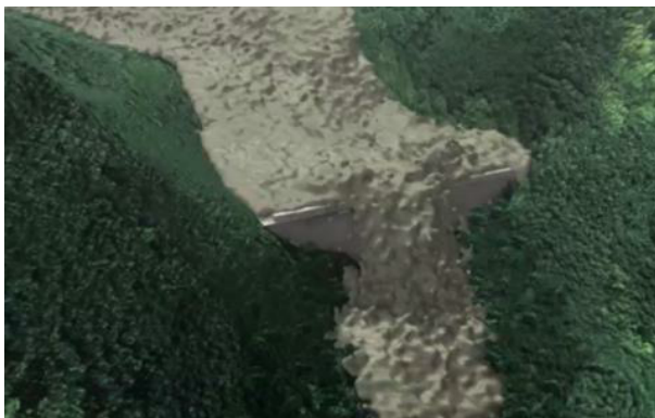
図 2-1 土石流に対する砂防ダムの効果
